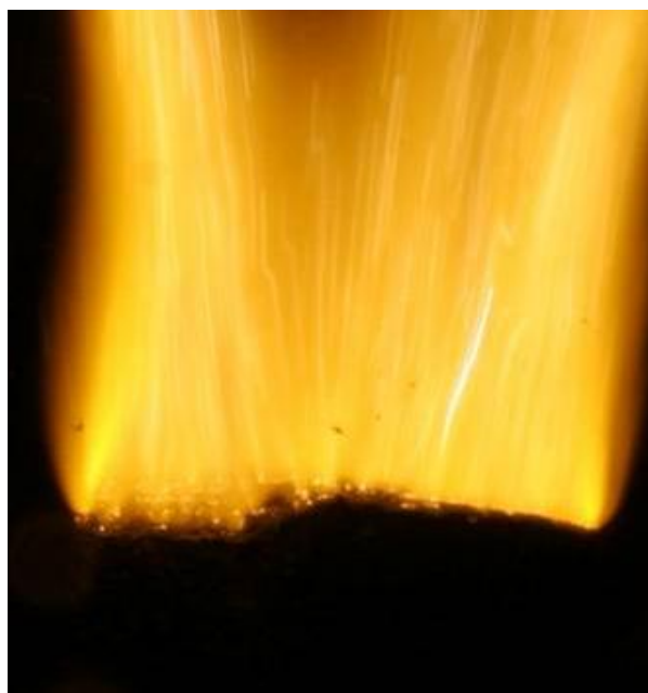
图 39 改性***基 TTJ 发动机试验火焰
