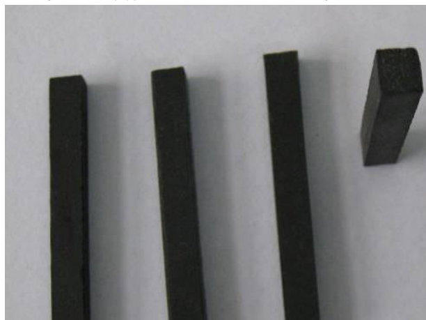
图 38 改性***基 TTJ 燃烧试验用的药条
