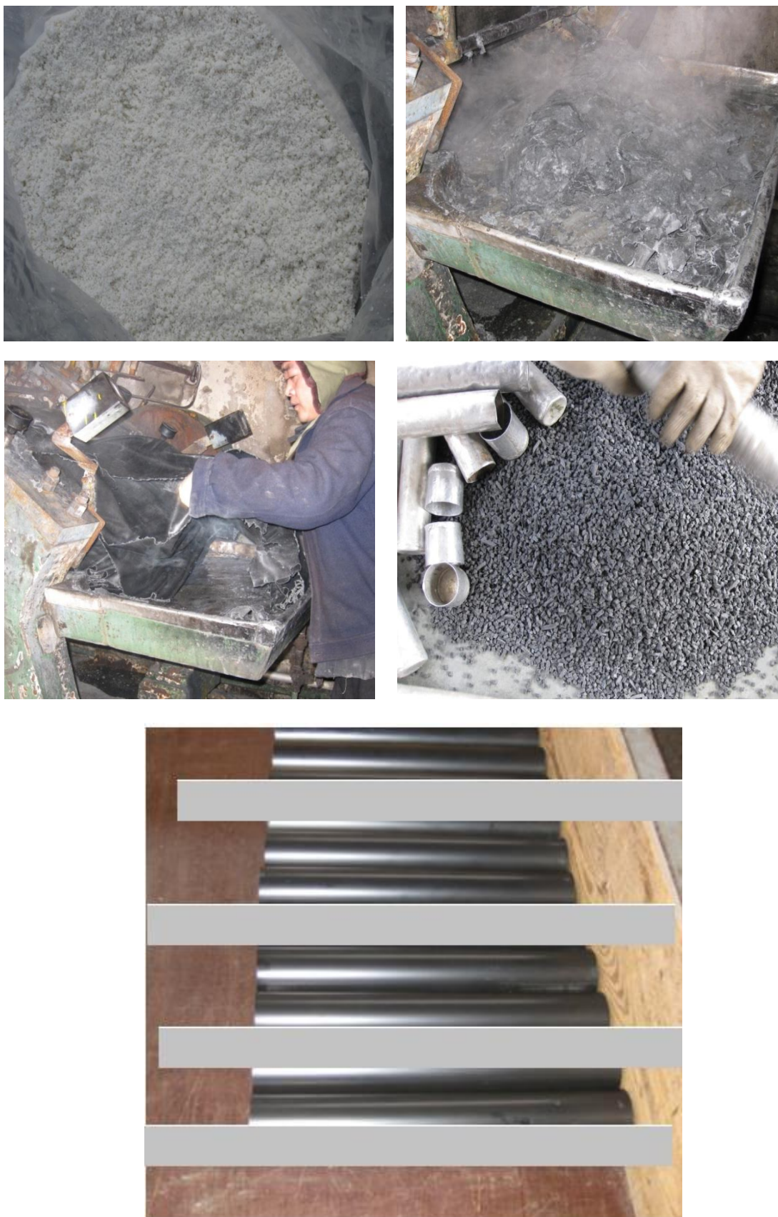
图 36 改性***产品及其 GSTTJ 的造粒与加工的产品药柱
